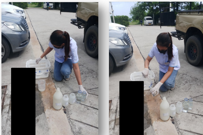
ภาพที่ 38 และ 39 แสดงภาพเก็บตัวอย่างน้ำทิ้งหลังบำบัด
