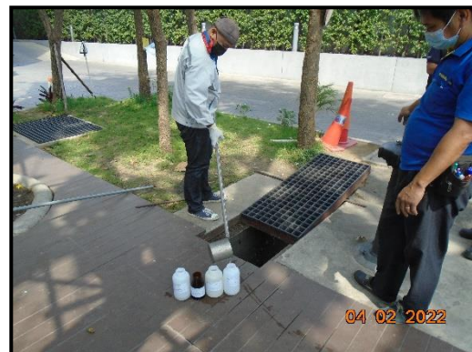
บ่อตรวจคุณภาพน้ำหลังผ่านระบบบำบัดน้ำเสียรวม
