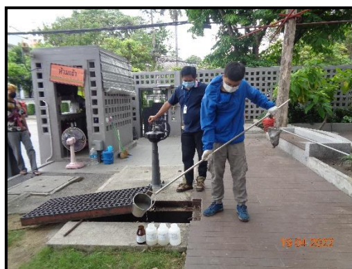
บ่อตรวจคุณภาพน้ำหลังผ่านระบบบำบัดน้ำเสีย
