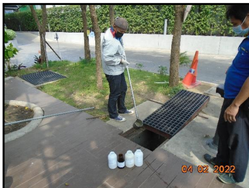
บ่อตรวจคุณภาพน้ำหลังผ่านระบบบำบัดน้ำเสียรวม
