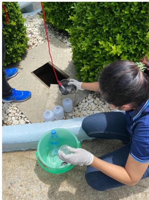
ภาพที่ 22 แสดงจุดเก็บและนำไปตรวจวิเคราะห์คุณภาพน้ำทิ้งหลังบำบัด
