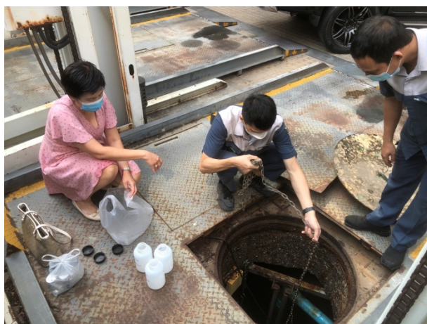
ภาพที่ 5 เก็บตัวอย่างน้ำทิ้งที่บ่อตรวจคุณภาพน้ำทิ้ง
