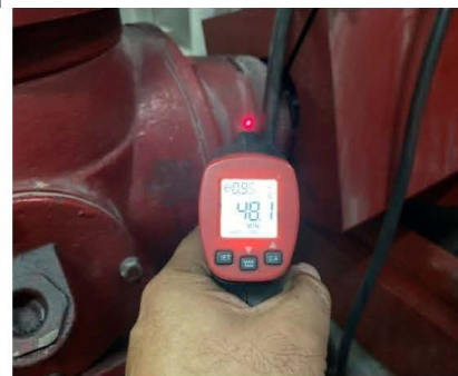
ภาพขณะตรวจวัดอุณหภูมิปั๊มขณะทำงาน
