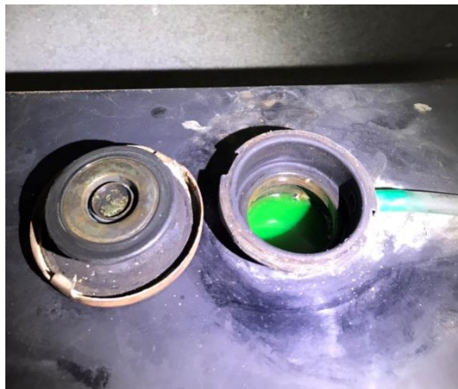
ขณะทำการตรวจเช็คระดับน้ำในหม้อน้ำ
