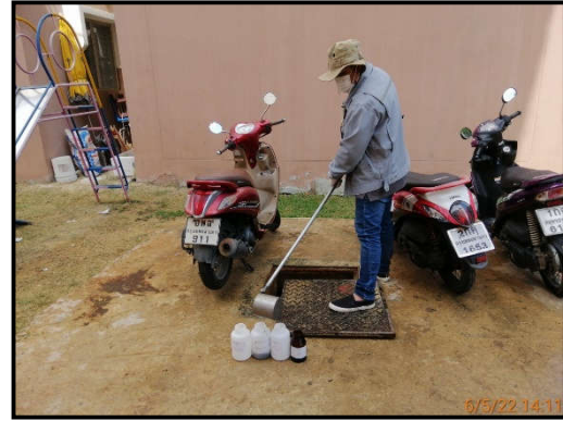
บ่อพักหลังผ่านระบบบำบัดน้ำเสียประจำอาคาร 5
