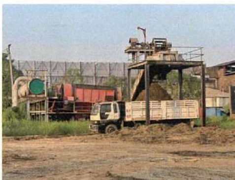
รูปที่ 3-22 โรตารีคัดแยกกากอ้อยก่อนเข้าสู่ระบบบำบัดน้ำเสีย
