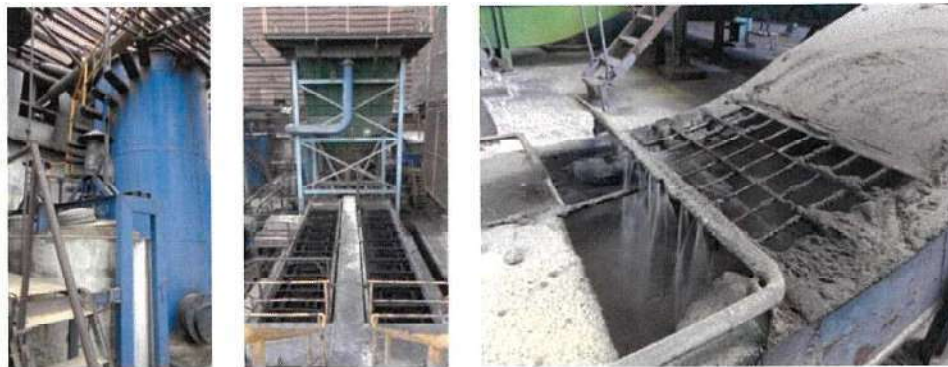
รูปที่ 2-19 ถังตกตะกอน (Clarifier) และ Ash Chain Conveyor
