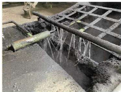
รูปที่ 3-14 ระบบสายพานลำเลียงแก้วระบบปิดและสเปรย์น้ำ
