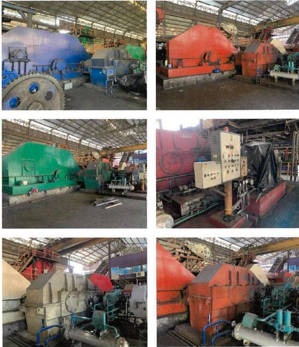
รูปที่ 3 28 อุปกรณ์ปิดครอบเครื่องจักรเพื่อลดระดับเสียงดัง
