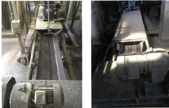
รูปที่ 3-14 (ต่อ) ระบบสายพานลำเลียงเข้าระบบปิดและสเปรย์น้ำ
