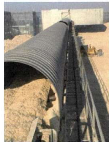
รูปที่ 2-10 ระบบสายพานโซ่ลำเลียงแบบปิดครอบ (Chain Conveyor)
