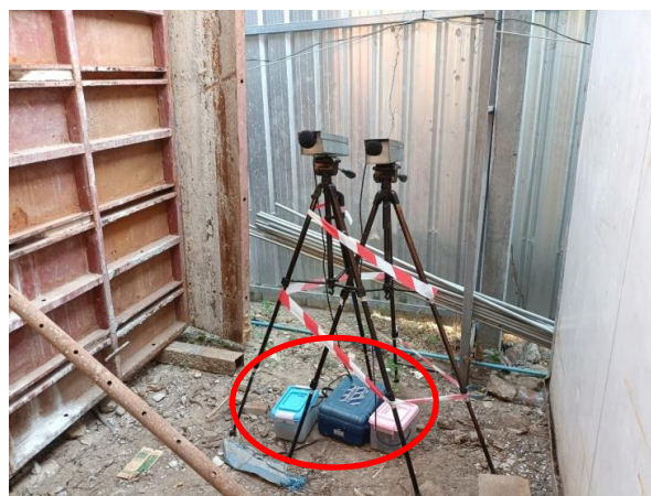
รูปที่ 3.16 การตรวจวัดความสั่นสะเทือน บริเวณพื้นที่โครงการ
