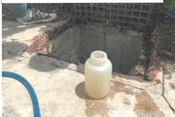
จุดตรวจเชื้อลิจิโอเนลลาในบริเวณท่อน้ำทิ้งเครื่องปรับอากาศ
