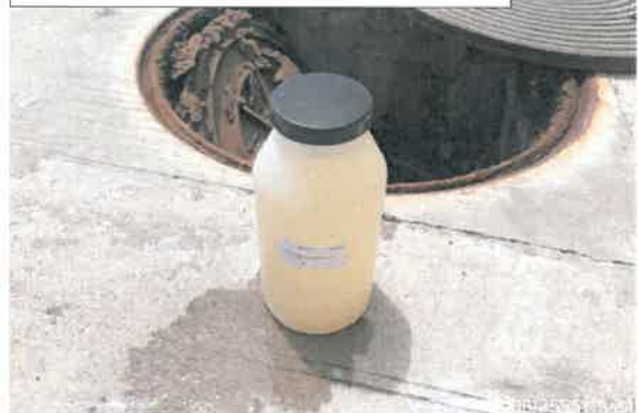
จุดตรวจคุณภาพน้ำทิ้งหลังออกกระบบบำบัดน้ำเสีย B
