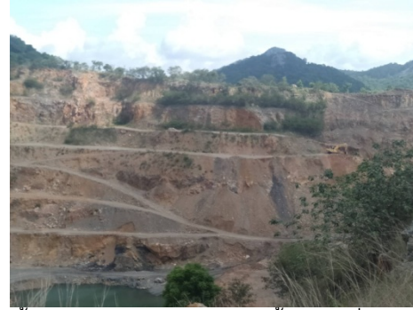
เดินหน้าเหมืองไปทางด้านทิศตะวันตก ปรับหน้าเหมืองเป็นขั้นบันได และปลูกต้นไม้ตามขั้นบันไดที่ไม่ได้ทำเหมืองแล้ว
