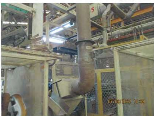
รูปที่ 25 ที่ระบายความร้อนจากเตาหลอม
