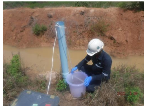
บ่อสังเกตการณ์ภายในฐานหลุมผลิต 10C ในทิศทางท้ายน้ำ : MWNSE-K (Down Gradient)
