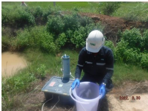
บ่อสังเกตการณ์ภายในฐานหลุมผลิต 10C ในทิศทางเหนือน้ำ : MWNSE-K (Up Gradient)
