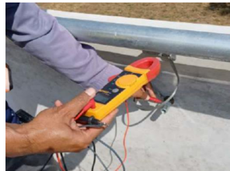
งานทดสอบระบบ Earthing and Bonding System
