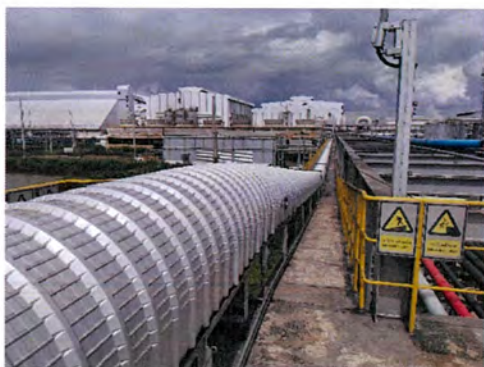
ภาพที่ 2-16 สายพานลำเลียงกากตะกอนหม้อกรองและถ้ำแบบปิด
