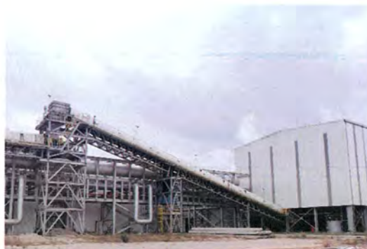
ภาพที่ 2-9 ระบบปิดครอบสายพานลำเลียงกากอ้อย
