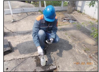
บ่อฟักน้ำทิ้งที่ออกจากถังตกตะกอนก่อนระบายออกสู่ภายนอกโครงการ รูปที่ 3-2 แสดงการเก็บตัวอย่างน้ำทิ้ง เดือนกุมภาพันธ์ 2564
