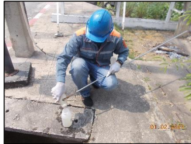
บ่อฟักน้ำทิ้งที่ออกจากถังตกตะกอนก่อนระบายออกสู่ภายนอกโครงการ รูปที่ 3-2 แสดงการเก็บตัวอย่างน้ำทิ้ง เดือนกุมภาพันธ์ 2564
