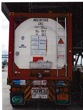
ภาพถ่ายที่ 2.2-11 (ต่อ) รถขนส่งกากของเสียที่ติดตั้งระบบ GPS และติดเบอร์โทรศัพท์ และการติดป้ายความเป็นอันตราย พร้อมอุปกรณ์ระงับเหตุ
