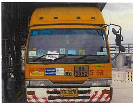
ภาพถ่ายที่ 2.2-11 รถขนส่งกากของเสียที่ติดตั้งระบบ GPS และติดเบอร์โทรศัพท์ และการติดป้ายความเป็นอันตราย พร้อมอุปกรณ์ระงับเหตุ
