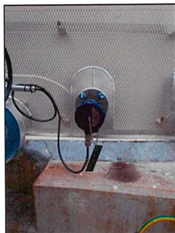
ภาพถ่ายที่ 2.2-35 อุปกรณ์ตรวจวัดอุณหภูมิของถังผลิตมันช์
