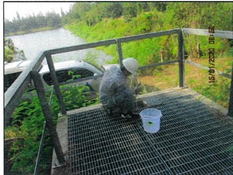
ภาพที่ 2.2-11 จุดเก็บตัวอย่างเพื่อตรวจวิเคราะห์คุณภาพ น้ำทั้งบริเวณ Inspection Manhole ของโครงการ
