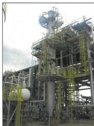
ภาพที่ 2.2-6 Wastewater Stripper เพื่อกำจัดไฮโดรคาร์บอนในน้ำ
