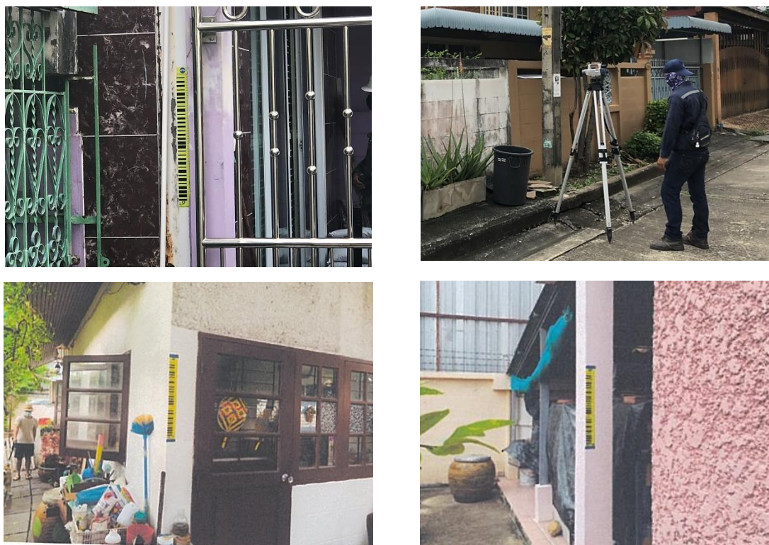
รูปที่ 3.6-1 การวัดค่าระดับการทรุดตัวของอาคาร และพื้นถนน
