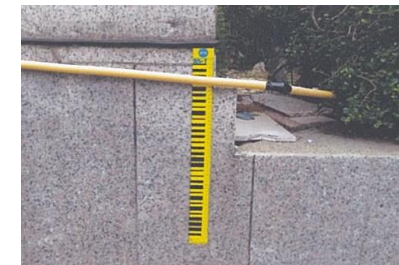
หมุดวัดการทรุดตัวของอาคาร BS2
