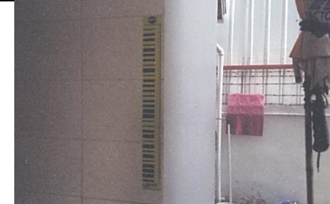
หมุดวัดการทรุดตัวของอาคาร BS17
