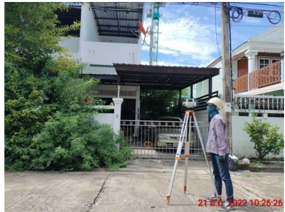
รูปที่ 20 การตรวจวัดการทรุดตัวของพื้น
