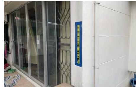
หมุดวัดการทรุดตัวของอาคาร BS54
