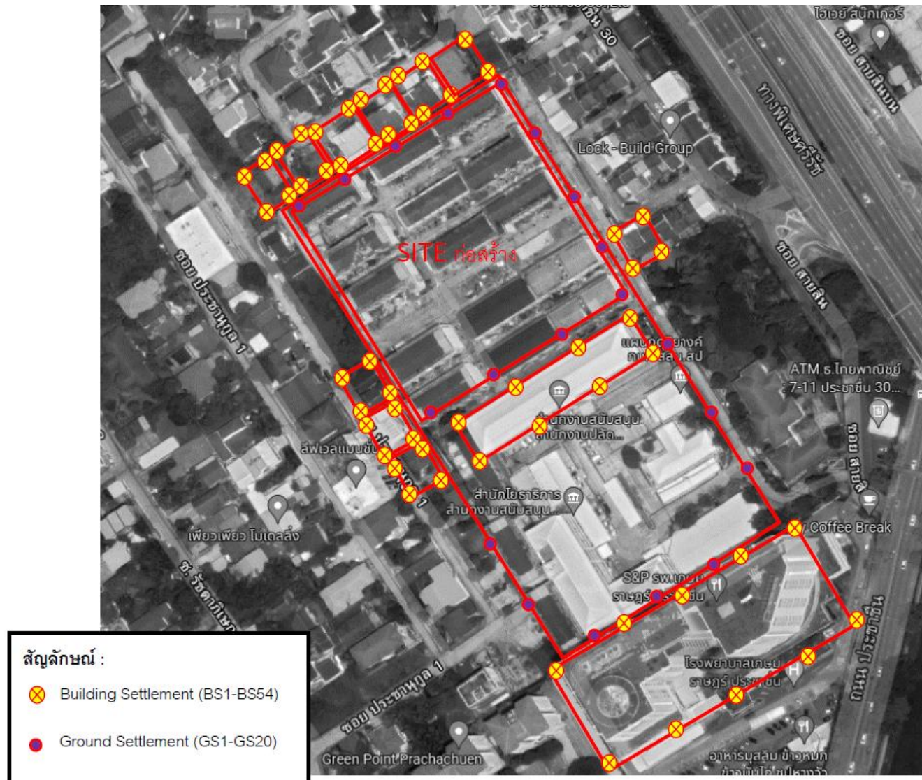
ภาพที่ 3-3 ตำแหน่งที่ติดตั้งเครื่องมือตรวจวัดการทรุดตัวของพื้นของโครงการ
