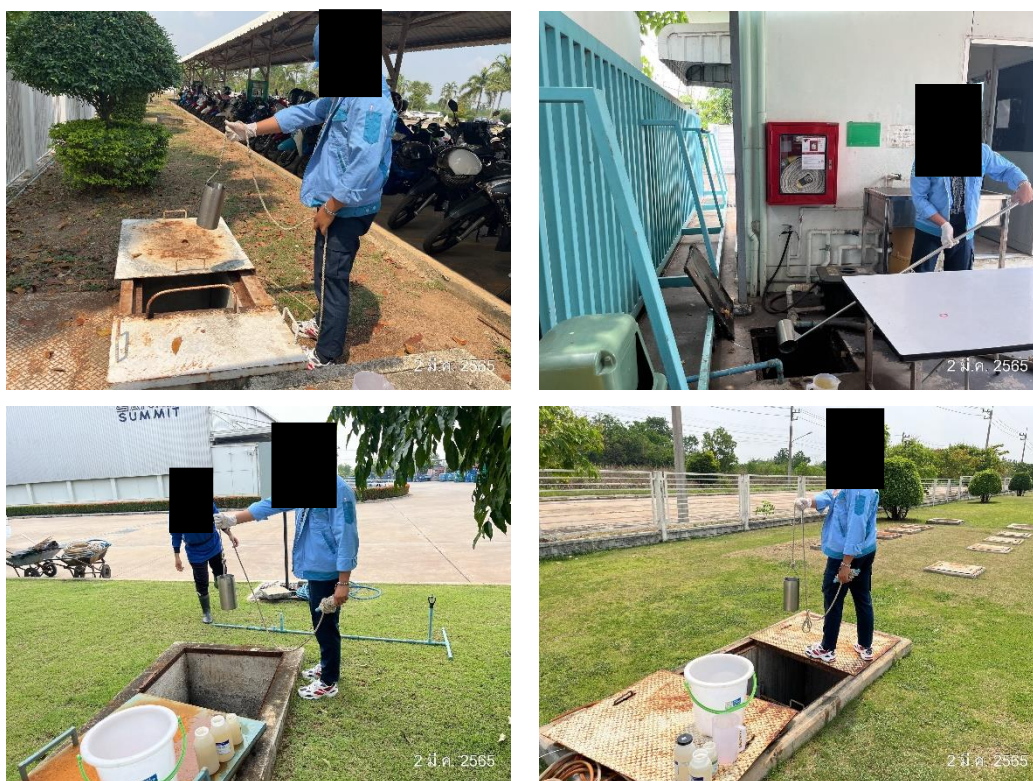
ภาพที่ 3.5.5-3 การเก็บตัวอย่างน้ำทิ้งโรงงานอุตสาหกรรม
