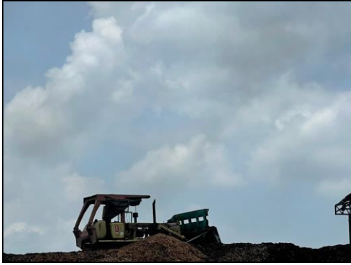
รูปที่ 12 การใช้รถแทรกเตอร์บดอัดขานอ้อย
