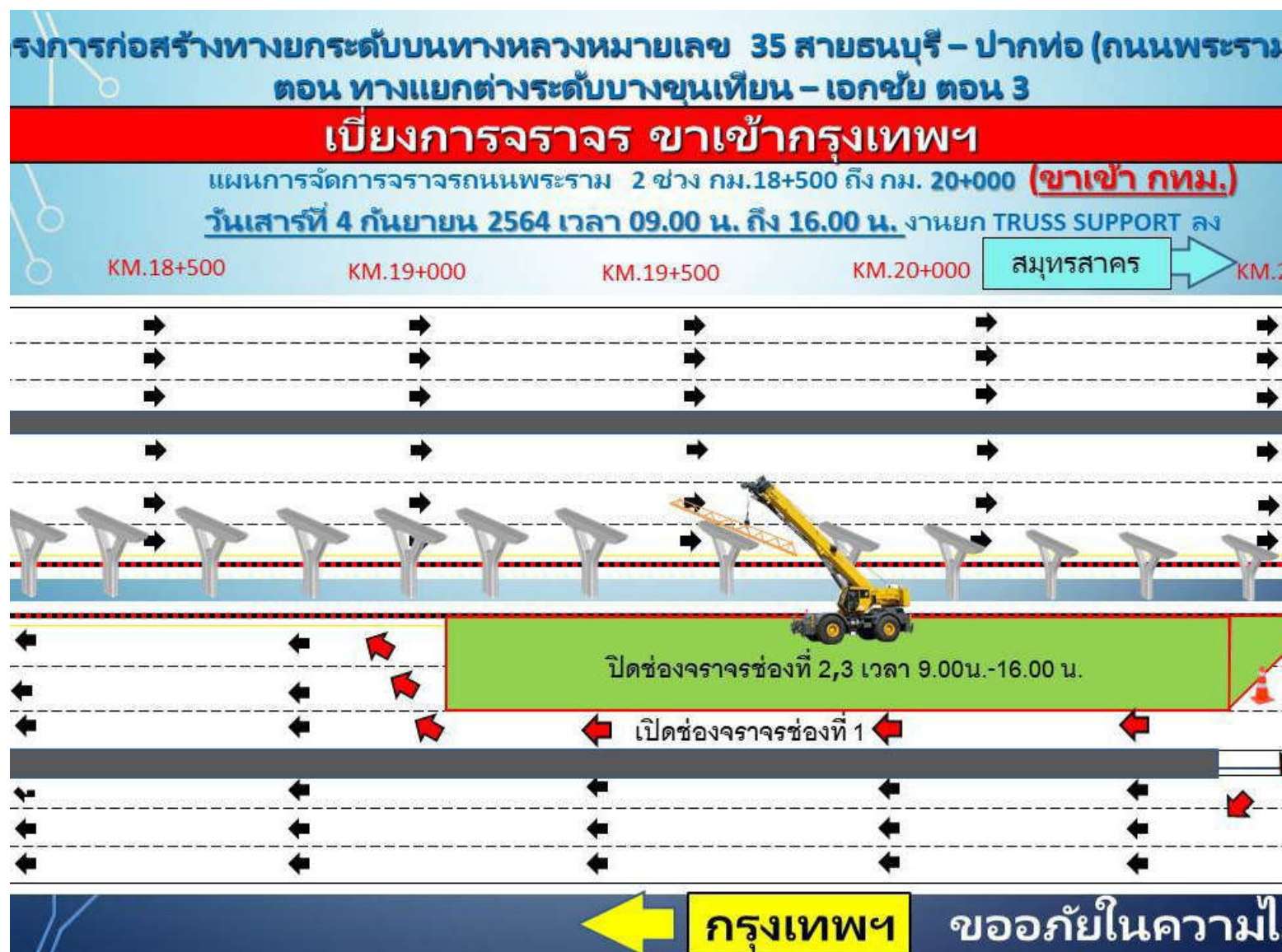
รูปที่ 5.2.8-4 การจัดการจราจรช่วงงานติดตั้งและรื้อย้าย Truss Support
