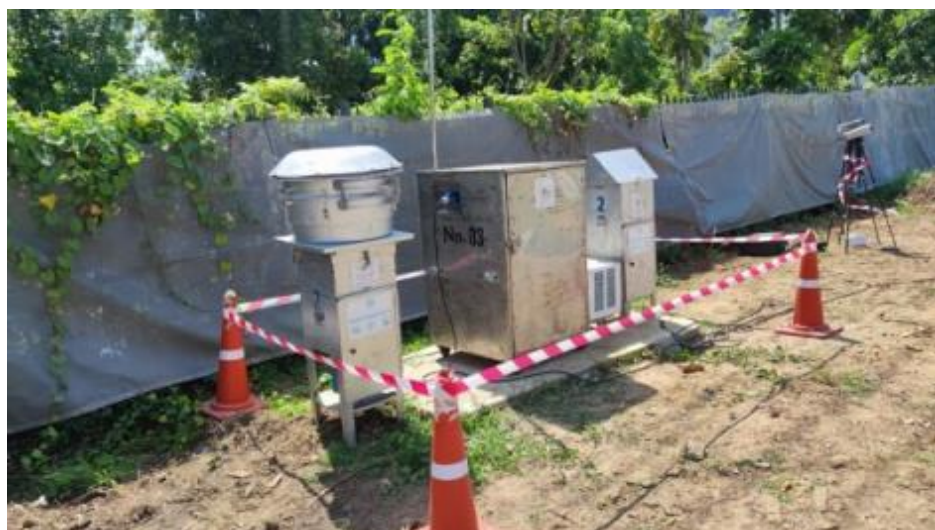
รูปที่ 3.2 การเก็บตัวอย่างคุณภาพอากาศในบรรยากาศ บริเวณพื้นที่โครงการ
