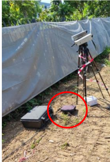
รูปที่ 3.40 การตรวจวัดความสั่นสะเทือน บริเวณพื้นที่โครงการ
