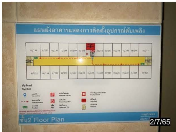
ภาพที่ 2-28 แผนผังตำแหน่งที่ติดตั้งอุปกรณ์ดับเพลิงต่างๆ
