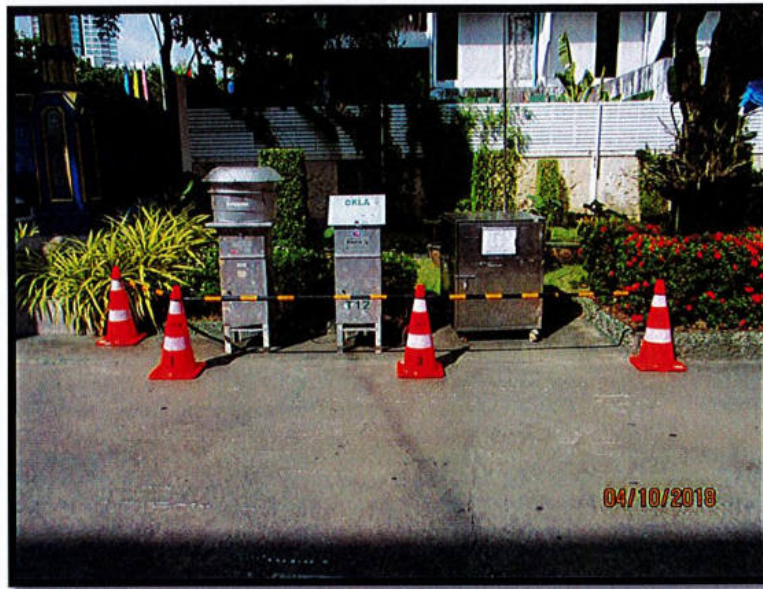
ภาพ แสดงการติดตั้งเครื่องมือตรวจวัดคุณภาพอากาศ
