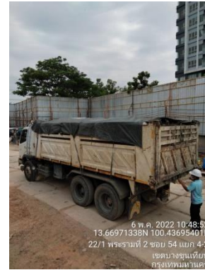
รูปที่ 2-5 ใช้ผ้าใบคลุมรถบรรทุกที่ใช้ขนส่งดิน วัสดุก่อสร้าง หิน ทราย
