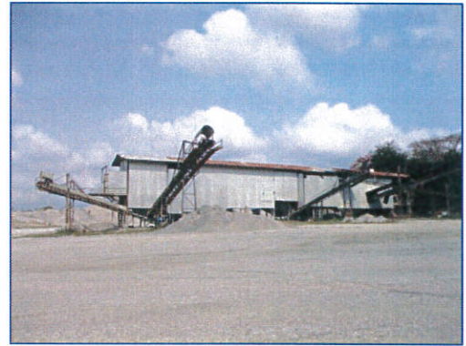
(4) การปิดคลุมอาคารโรงโมและสายพานลำเลียง
