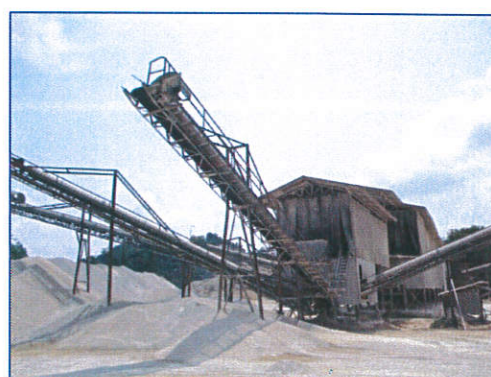
(14) การปิดคลุมอาคารโรงโม่และสายพานลำเลียง
