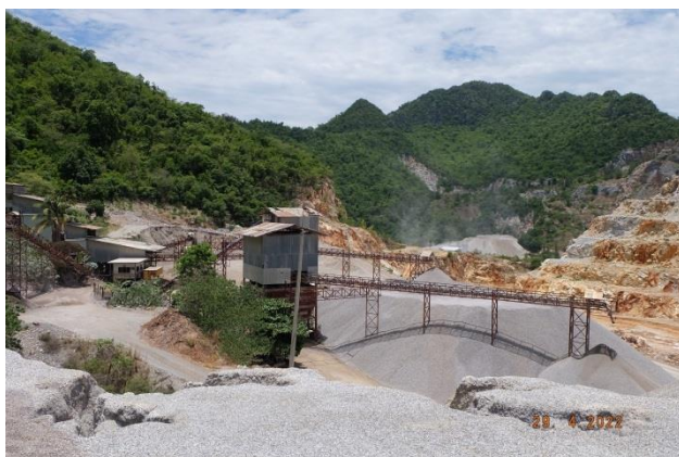
ภาพที่ 2-12 โรงโม่หินของโครงการปิดคลุม 3 ด้าน และการฉีดสเปรย์น้ำบริเวณปากโรงโม่
