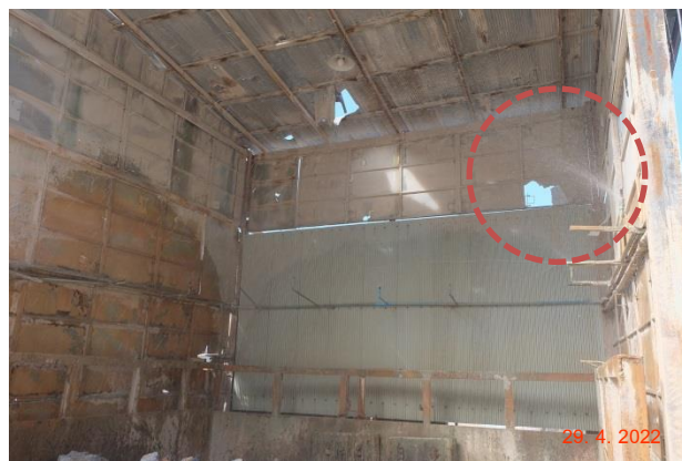
ภาพที่ 2-12 โรงโม่หินของโครงการปิดคลุม 3 ด้าน และการฉีดสเปรย์น้ำบริเวณปากโรงโม่
