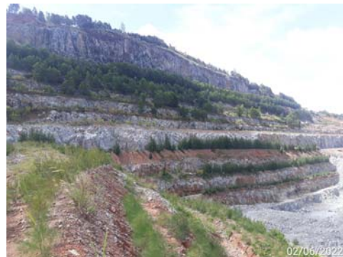
(11) การฟื้นฟูชั้นดินหน้าเหมืองที่ไม่ใช่ประโยชน์ เพื่อการทำเหมืองแล้ว
