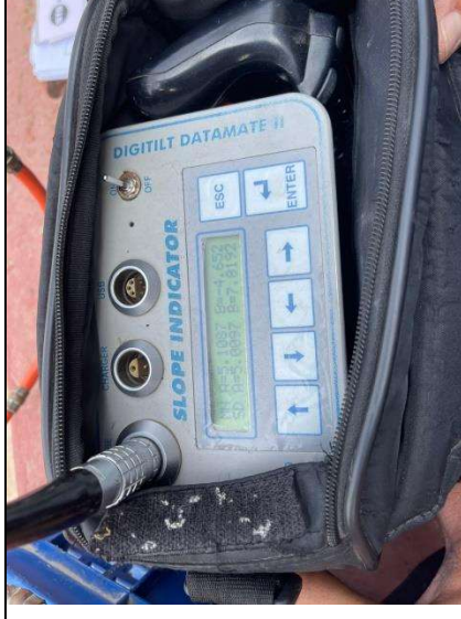
รูปที่ 3-38 การตรวจวัดการเคลื่อนตัวของดินโดย Inclinometer
