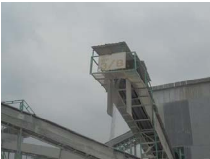
รูปที่ 2-15: ปลอกายปลายสายพาน
