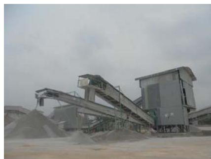
รูปที่ 2-13: การปิดคลุมสายพานลำเลียง
