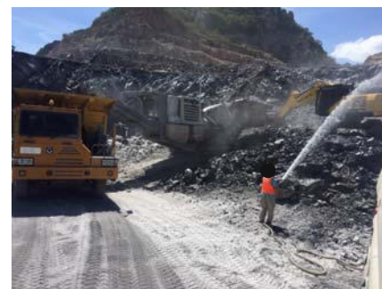
รูปที่ 2-29: การฉีดพรมน้ำ Mobile Crushing
