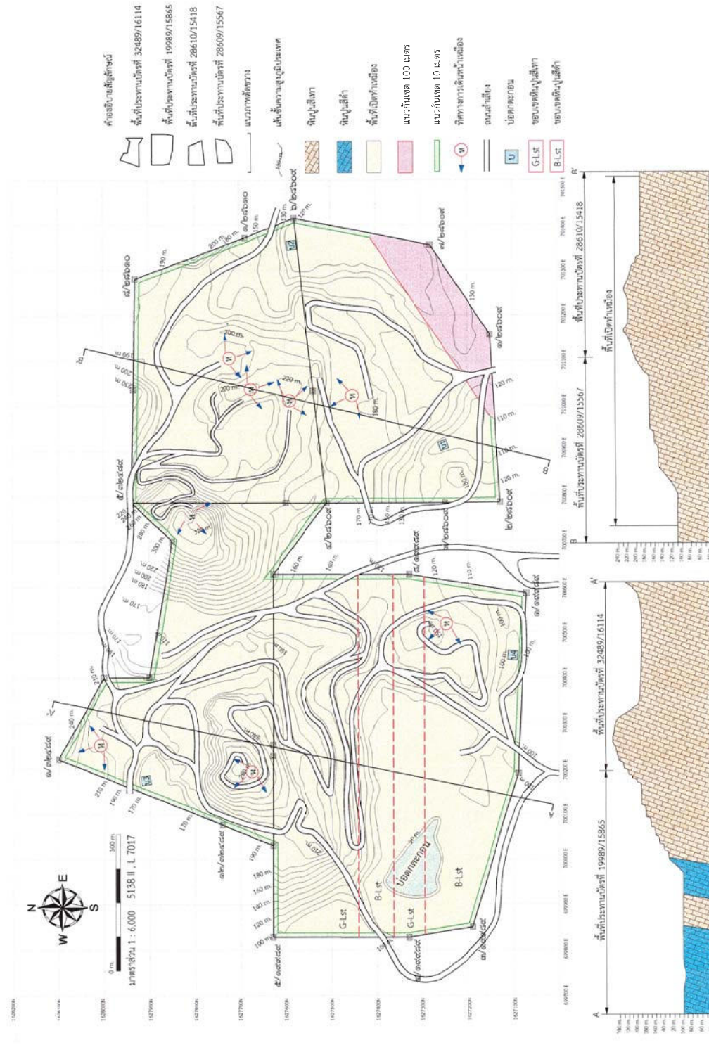
รูปที่ 1-2: แบบแปลนการทำเหมือง (Mine Layout) และภาพตัดขวางบริเวณพื้นที่โครงการ
