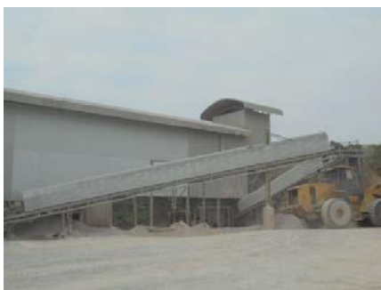
รูปที่ 2-27: การปิดคลุมสายพานลำเลียง
