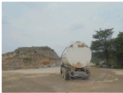
รูปที่ 2-8: การฉีดพรมน้ำบริเวณหน้าเหมือง
