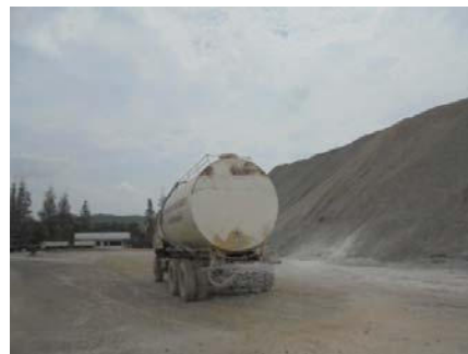
รูปที่ 2-11: การฉีดพรมน้ำบริเวณลานกองแร่
