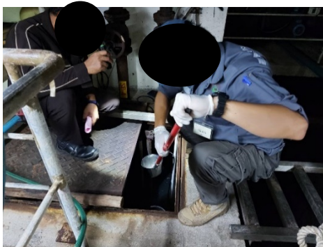
(2) จุดระบายน้ำออกจากระบบ - บ่อเก็บน้ำที่ผ่านการบำบัด (Clear Water Tank)
