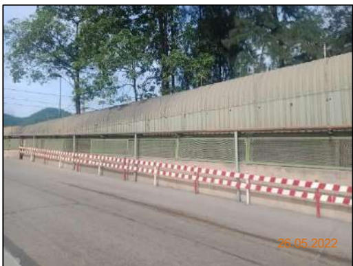
รูปที่ 2-23 การขนส่งลำเลียงแร่ โดยใช้ Overland Belt Conveyor System ที่มีฝาปิดตลอดแนว
