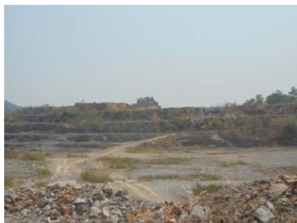
รูปที่ 2-3: การทำเหมืองแบบชั้นบันได
