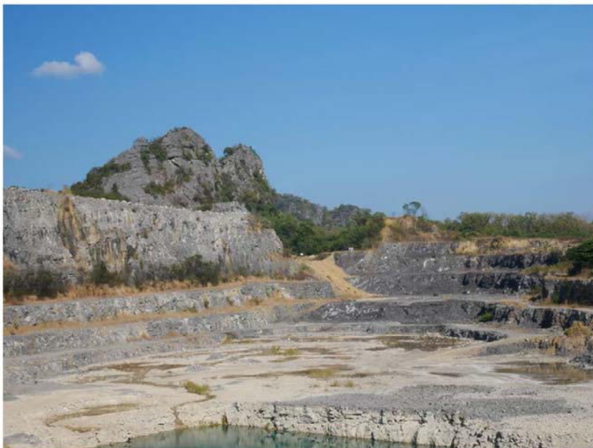
รูปที่ 2: การทำเหมืองแบบชั้นบันได
