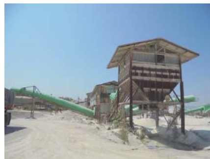
รูปที่ 2-8: การปิดคลุมโรงโม่หิน
