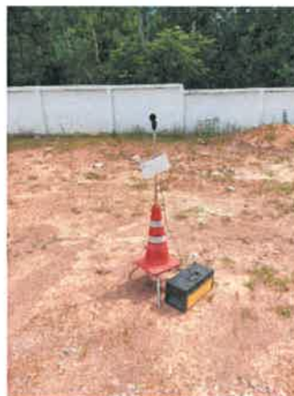
รูปที่ 2-13 แสดงการติดตั้งอุปกรณ์เครื่องตรวจวัดฝุ่น เสียง และสั่นสะเทือนภายในพื้นที่ก่อสร้าง
