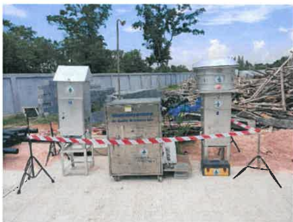
รูปที่ 2-13 แสดงการติดตั้งอุปกรณ์เครื่องตรวจวัดฝุ่น เสียง และสั่นสะเทือนภายในพื้นที่ก่อสร้าง
