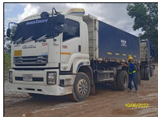
ภาพที่ 2.19 การใช้ผ้าใบปิดคลุมกระบะท้ายรถบรรทุกให้มิดชิด
