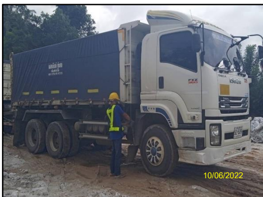
ภาพที่ 2.19 การใช้ผ้าใบปิดคลุมกระบะท้ายรถบรรทุกให้มิดชิด
