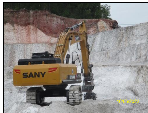
ภาพที่ 2.16 การใช้เครื่องจักร Surface Miner มาใช้ในการทำเหมือง
