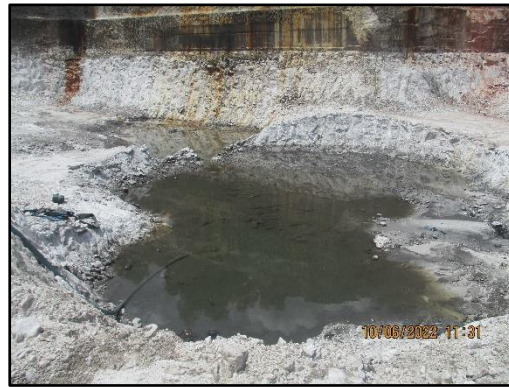
ภาพที่ 2.21 ป่อกักเก็บน้ำ (sump)
