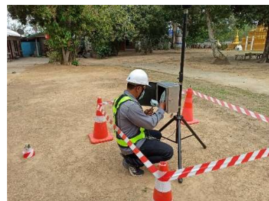
ภาพที่ 5.2-1 การตรวจวัดระดับเสียง ท่าอากาศยานปาย (มีนาคม พ.ศ.2565)
