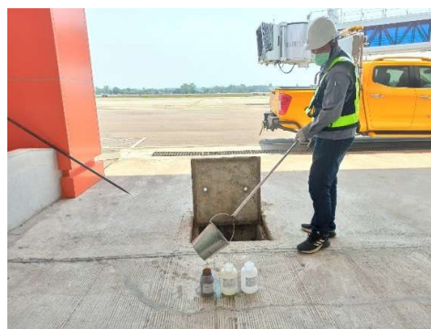
ภาพที่ 5.5-1 การเก็บตัวอย่างคุณภาพน้ำหลังผ่านการบำบัดน้ำเสีย ท่าอากาศยานนานาชาติแม่สอด (วันที่ 31 มีนาคม พ.ศ.2565)
