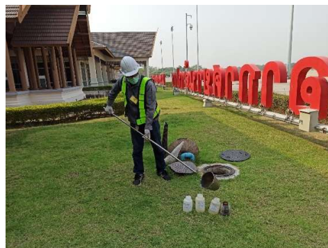
ภาพที่ 5.2-1 การเก็บตัวอย่างคุณภาพน้ำทิ้งผ่านการบำบัดน้ำเสีย ท่าอากาศยานลำปาง (วันที่ 28 มีนาคม พ.ศ.2565)
