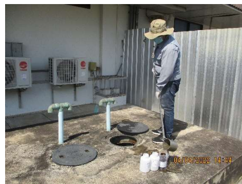
ภาพที่ 5.4-1 การเก็บตัวอย่างคุณภาพน้ำหลังการบำบัดน้ำเสีย ท่าอากาศยานแพร่ (วันที่ 4 เมษายน พ.ศ.2565)
