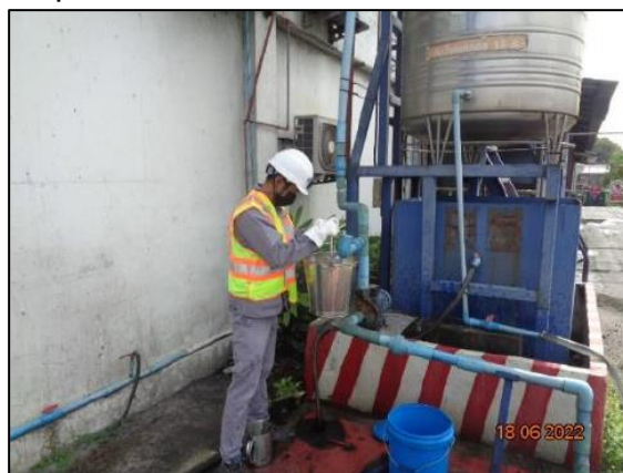
รูปที่ 3.1 การเก็บตัวอย่างคุณภาพน้ำทิ้งบริเวณจุดที่ 1 บ่อพักน้ำเสียก่อนเข้าระบบบำบัดและกำจัดไขมันของท่าเรือ B1
