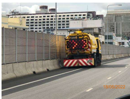
รูปที่ 2-7 การทำความสะอาดพื้นผิวจราจรด้วยรถดูดกวด
