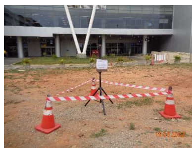
ภาพที่ 5.1-1 การตรวจวัดระดับเสียง ท่าอากาศยานนานาชาติขอนแก่น (มีนาคม พ.ศ.2565)
