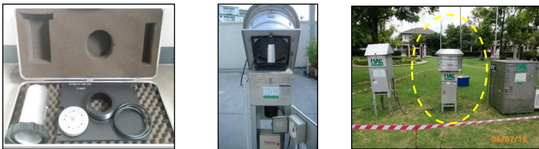
รูปที่ 3-3 การปรับเทียบและติดตั้งเครื่องมือเก็บตัวอย่างฝุ่นละอองขนาดไม่เกิน 10 ไมครอน (High Volume Air Sampler)
