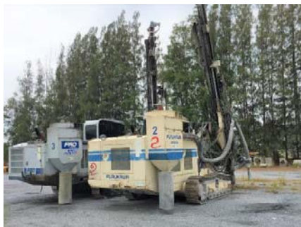
รูปที่ 2-26: รถเจาะรูระเบิดแบบดินตะขาบ
