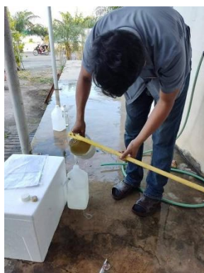
เก็บตัวอย่างน้ำเข้าระบบบำบัดน้ำเสีย
