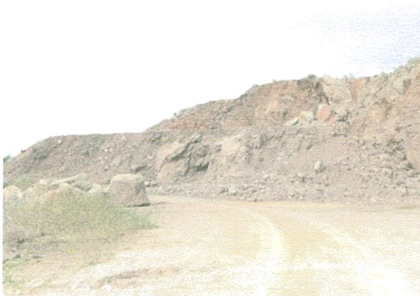
รูปที่ 2 การเปิดหน้าเหมืองเป็นชั้นบันไดบริเวณตอนกลางของประทานบัตร
