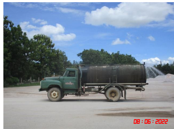
รูปที่ 2-7 การฉีดพรมน้ำบริเวณโรงโม่หิน และเส้นทางลำเลียงหิน
