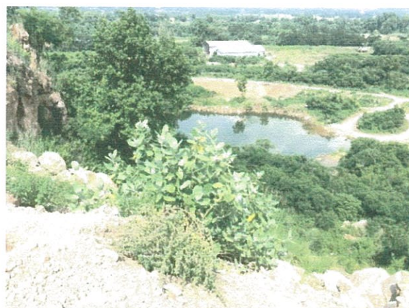
รูปที่ 6 Sump ที่ 1 รองรับน้ำขุ่นข้นและตะกอนดินที่ เกิดจากการชะล้างบริเวณหน้าเหมือง
